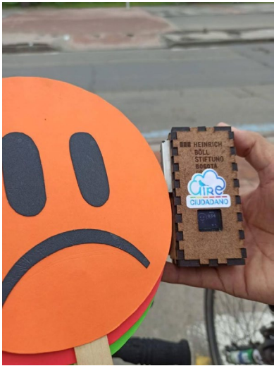
Figura 2A. Superior Registros de concentraciones de PM 2,5 durante el recorrido en bicicleta. B. Medidor de material particulado AireCiudadano®.
